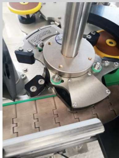
Stella entrata/uscita multiformato Multiformat in/out star wheel Stoile entrée/sortie multiformats Estrella multiformato para entrada y salida Mehr-formatige Sterne am Ein-/Ausgang
